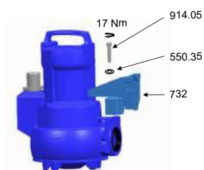
Fig. 10: Montar o suporte na versão com 1 barra
