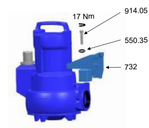
Fig. 10: Montaggio supporto con guida per 1 barra
