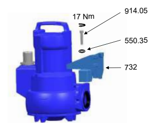
Fig. 10: Montaje del soporte con 1 barra guía
