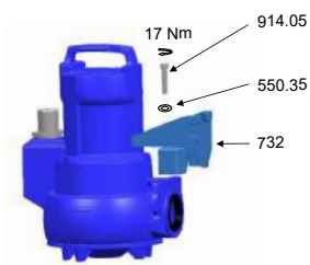
Abb. 10: Halterung montieren bei 1-Stangenführung
